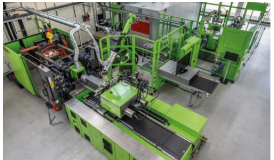
Automatisierte Spritzgießproduktionszelle für die Fertigung thermoplastischer Leichtbauteile von ENGEL
