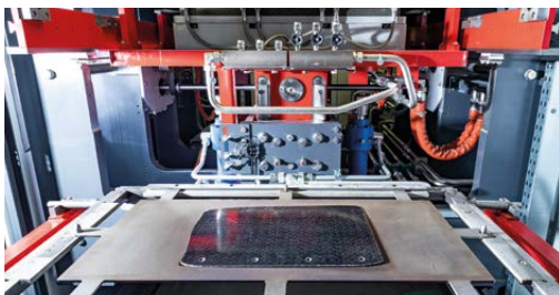
Konsolidieranlage für orientierte Fasergelege von FILL
